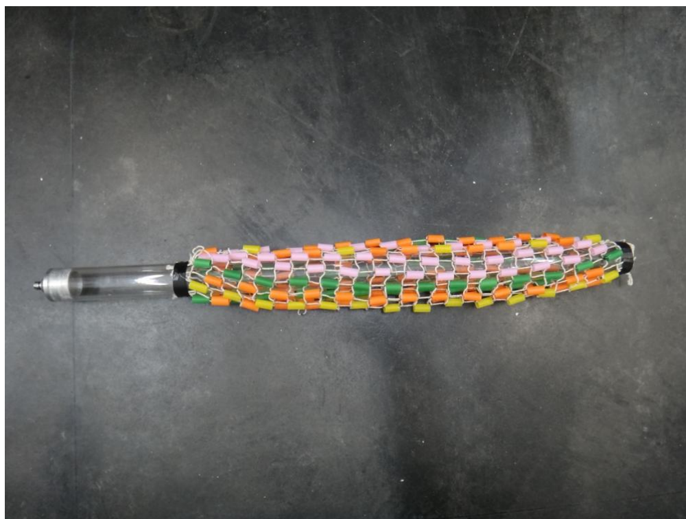
Figura 29: foto do cilindro com a malha de “bobbins” cilíndricos grandes
