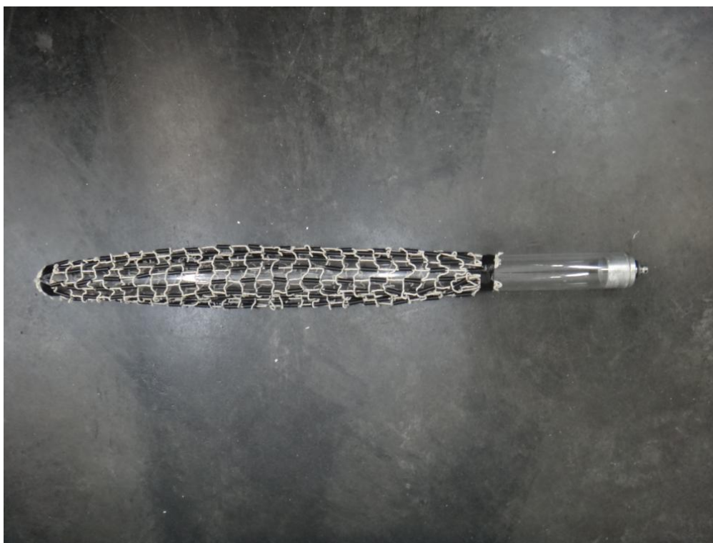
Figura 25: foto do cilindro com a malha de “bobbins” cilíndricos médios
