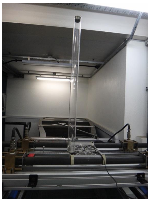
Figura 10: Sistema montado para fazer o teste de decaimento no ar.
