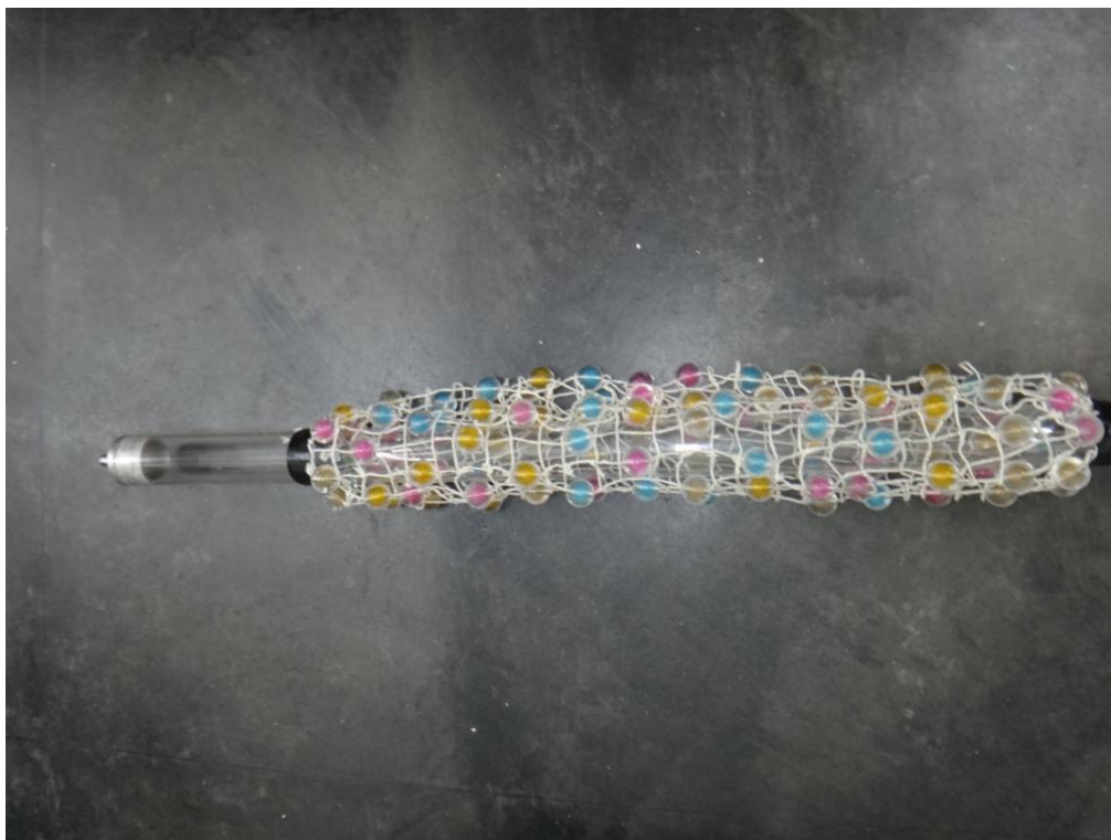
Figura 33: foto do cilindro com a malha de “bobbins” esféricos
